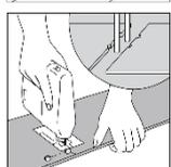
9. Agujeros para tuberías: medir el diámetro de la tubería y perforar un agujero de 20 mm de más. Corte un pedazo, como se muestra en la figura y ponga la placa en su sitio. Luego, coloque la pieza recortada en su lugar.
